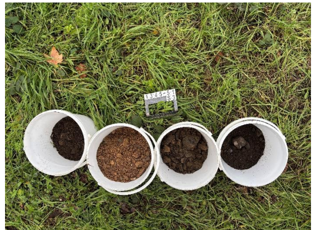
Bild 10: Bohrkern an der Stelle S 3
